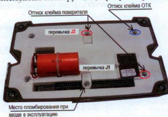
Рисунок 2 – Места пломбирования вычислителя
